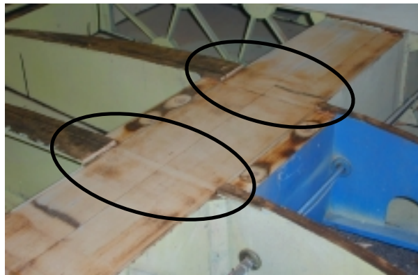
Photo 3 : exemple d'avion avec des renforts de marchepied intègres donc seule la partie recouvrant le longeron a été enlevée.
